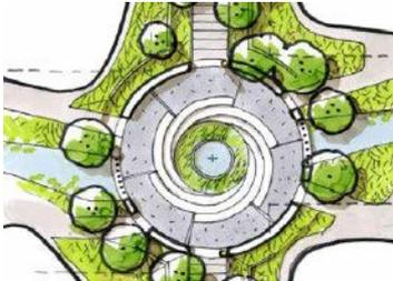
La place centrale comprendra un bassin formant une « spirale » d'eau. Les berges en gradin seront végétalisées. Après modelage du terrain, il sera mis en œuvre une étanchéité par membrane bitumineuse qui recevra une protection par une dalle béton de 6cm d'épaisseur. À la suite il sera mis en œuvre différents systèmes d'arrêts des terres (plats pvc, murets préfa en béton, etc..) permettant la mise en place de plantes aquatiques.
