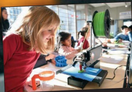
Pour cela il faut une imprimante spéciale dans laquelle l'encre est remplacée par des bobines de fil plastique. Là tu n'obtiens plus un carré sur une feuille de papier mais un cube en plastique !
