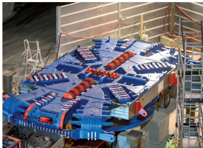
La roue de coupe est la partie avant du tunnelier : c'est elle qui creuse, mais elle est suivie d'un véritable train-usine qui consolide le tunnel et évacue les déblais au fur et à mesure de l'avancée.
