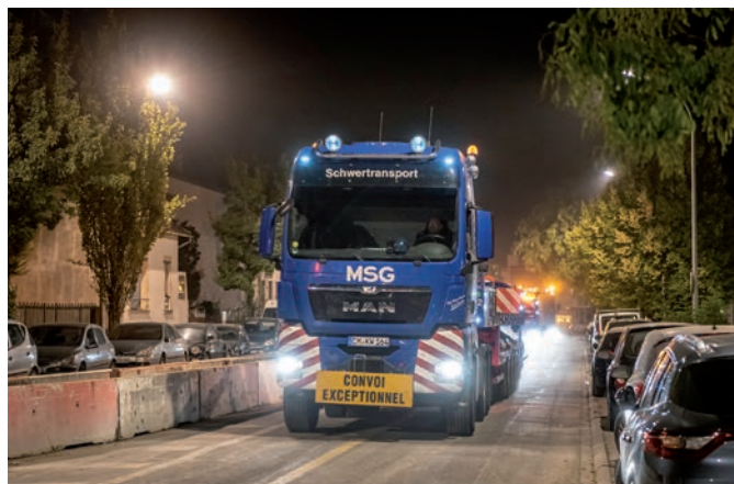
Une quarantaine de convois exceptionnels ont acheminé les pièces du tunnelier jusqu'au parc Robespierre entre la mi-septembre et la fin novembre. Des camions venus de l'usine allemande Herrenknecht, où le tunnelier est fabriqué.
