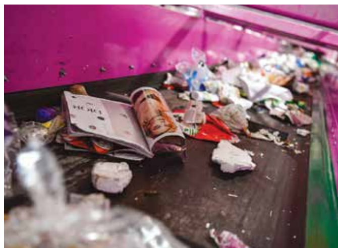
Ce processus automatisé est parfois entravé par de mauvais réflexes. "Les films des cassettes VHS, les textiles ou les parapluies endommagent gravement les machines. Il faut aussi éviter d'imbriquer les emballages les uns dans les autres."
