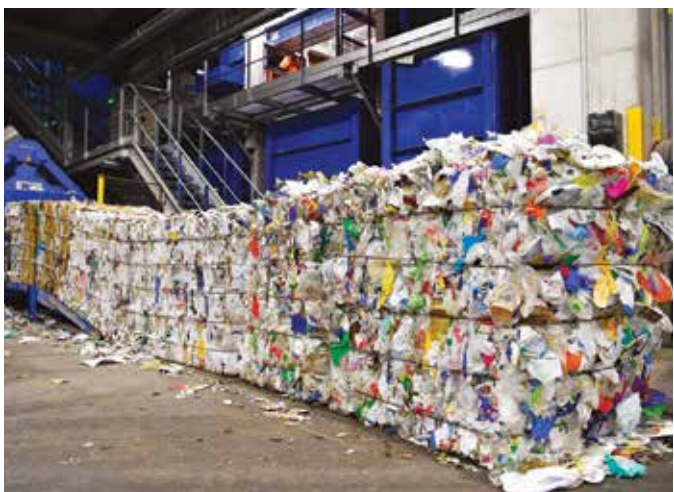
Dans l'espace de stockage, les presses s'actionnent automatiquement pour former des "balles" triées par type de matériaux. Des montagnes de plastiques clairs ou foncés y côtoient des amas de métal et de papier.
