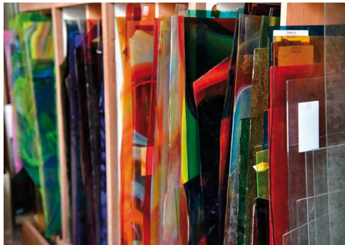
D'Allemagne, de Pologne ou de France, Gilles se procure du verre teinté dans la masse en fonction des couleurs dont il a besoin. Selon les oxydes métalliques utilisés par les souffleurs de verres (Sélénium, Fer, Or...) les plaques de verres prennent des teintes bariolées différentes (jaune, vert, rose,...)
