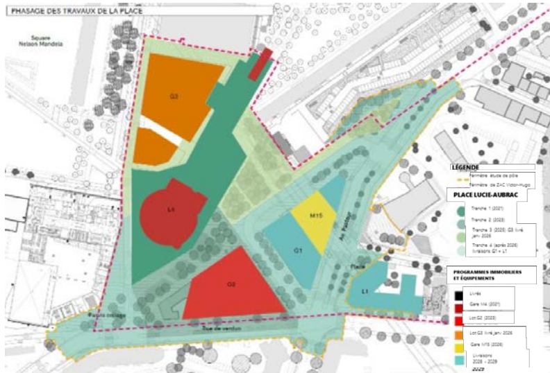
Organisation des travaux au fur et à mesure des projets immobiliers
