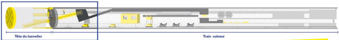
Quand on pense au tunnelier on pense d'abord à la roue de coupe ①, le grand disque de 10 mètres de large qui creuse la roche à la manière d'une râpe à fromage géante. Mais pour que le sol ne s'écroule pas aussitôt derrière elle, il faut construire un anneau de béton ⑤ qui résiste à la pression des sols et qui formera un tuyau de 33 km : c'est l'enveloppe définitive du tunnel.
