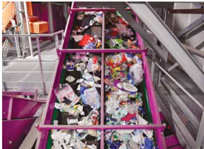
Le processus de tri se divise en quatre flux, matérialisés par une couleur chacun. Le carton et le papier sont transportés par un tapis violet tandis que les plastiques et le métal suivent l'itinéraire orange.
