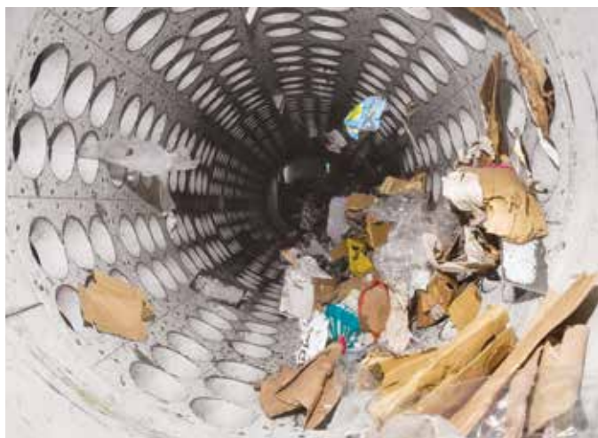
Les déchets alimentent ensuite le trommel : une sorte de tambour de machine à laver percé de trous de différentes dimensions. "Cela permet de les séparer en fonction de leur taille et du matériau utilisé."
