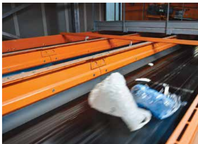
Pour s'adapter à l'extension des consignes de tri, le centre s'est équipé de machines aux technologies innovantes, comme le trieur optique. "Son faisceau lumineux reconnaît les différents types de plastiques et de papier."
